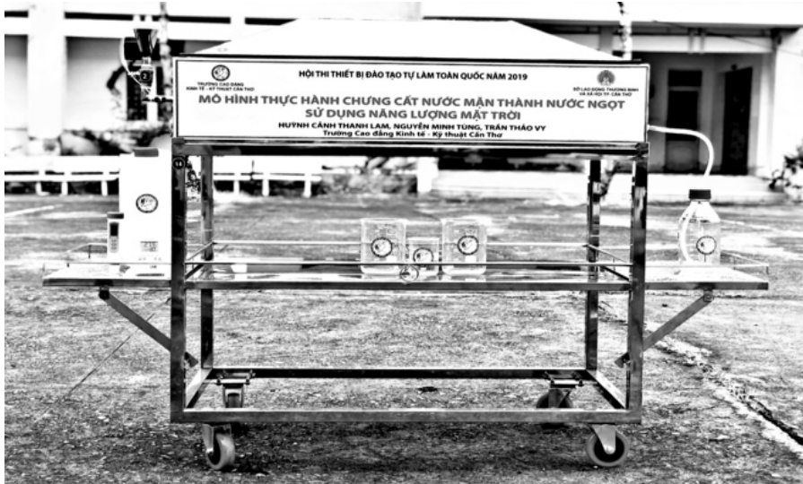
Hình 1. Mô hình sử dụng Năng lượng Mặt trời chưng cất nước mặn thành nước ngọt
